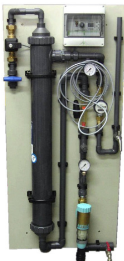
Abb. 9: Ultrafiltrationsanlage zur Sterilfiltration von Trinkwasser
