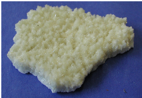
Abb. 5: Kalk in Form von Aragonit aus einem Warmwasserspeicher. Die zerklüftete Struktur bietet Mikroorganismen vorzügliche Schutzräume.
